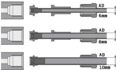
De binnendraad kan eveneens de GOK universele aansluitgarnituur type UA opnemen, die overeenkomt met een klemverbinding van het uitvoeringstype G conform EN 12514-4 bijlage D.
